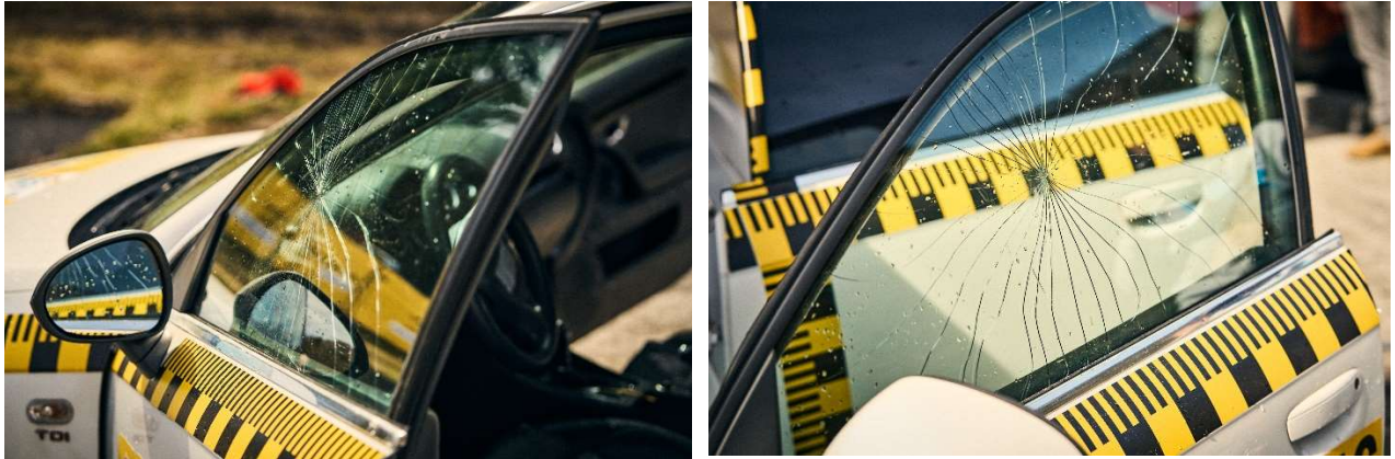
Barsten aan de binnenkant van zijruit door het slaan met de hoofdsteun. Aan de buitenkant is de ruit niet beschadigd.
