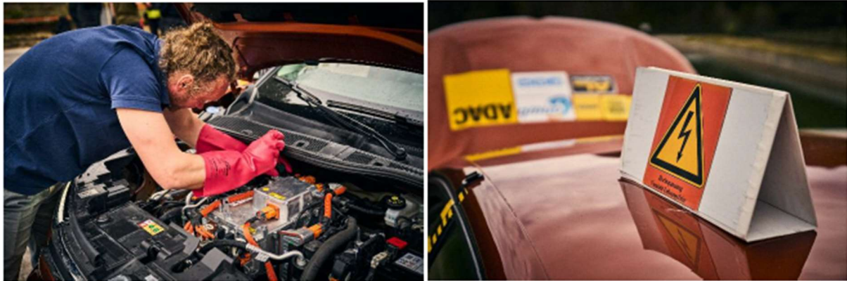
Loskoppelen van het hoogspanningscircuit via de HV-Disconnect door een specialist.
