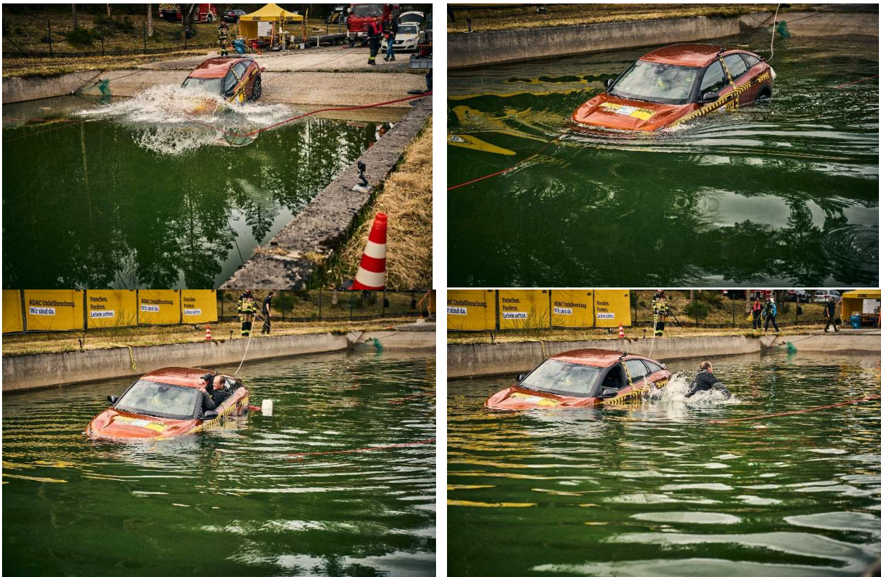
Boven links, auto rijdt het bassin in en blijft enige tijd drijven. De bestuurder opent het elektrische zijraam en klimt uit de auto.
