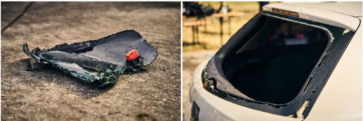
De vernielde achterrait, nog één geheel vanwege de aanwezige folie.
