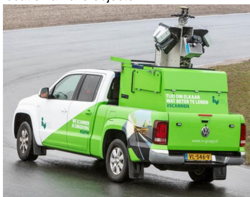
Figuur 1 Laserscanauto (links) en puntenwolk (rechts)
