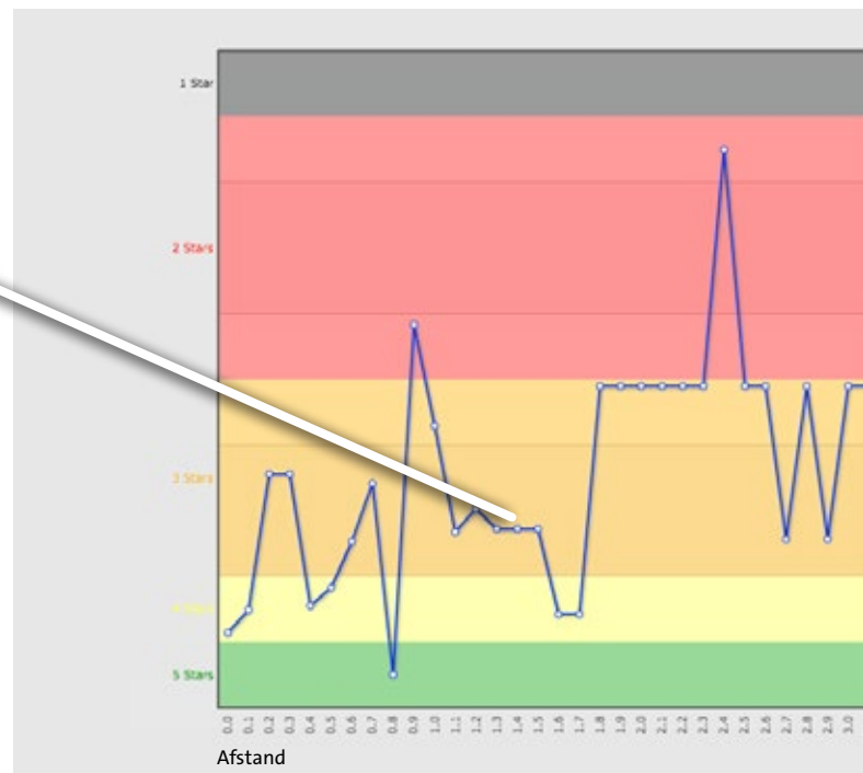
▲ N254, Middelsburgse Schoeweg. De weg heeft een doorstroombaan en is ingericht als autoweg (maximum snelheid 100 km/uur). Dit wegdeel scoort 3 sterren. De factoren die de veiligheid positief beïnvloeden zijn: de fysieke rijbaanscheiding met middenberm (breder dan 5 meter) en de berm zonder obstakels. Verder zijn er weinig kruispunten of invoegstroken. De factor die de score negatief beïnvloedt is het ontbreken van een redresseerstrook aan de rechterzijde.
